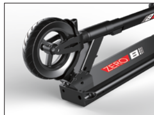
Krok 6: Zvedněte skládací páčku a současně zatačte na řídicí tyč dopředu, abyste uvolnili skládací mechanismus. Držte páčku stisknutou a sklapte řídicí tyč dolů směrem k plošině, dokud nezapadne do své polohy.
