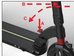
Krok 6: (A) Stlačte dolů skládací páčku a zatačte řídicí tyč dopředu (B) abyste odemkli spojení. Držte páčku stisknutou dolů (A) a sklapte řídicí tyč směrem k plošině (C), dokud nezapadne do své polohy.
